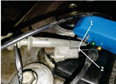
Fig. 3. Conexión de Inyector
