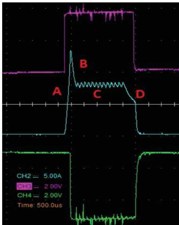
Fig. 16. Oscilograma del módulo EDU con consumo de corriente de un inyector.
