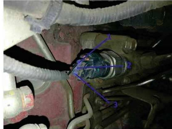
Fig. 1 Sensor de presión de riel.
