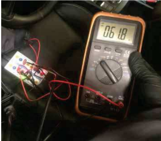
Figura 7. Resistencia de red entre MS CANL, MS CANH
