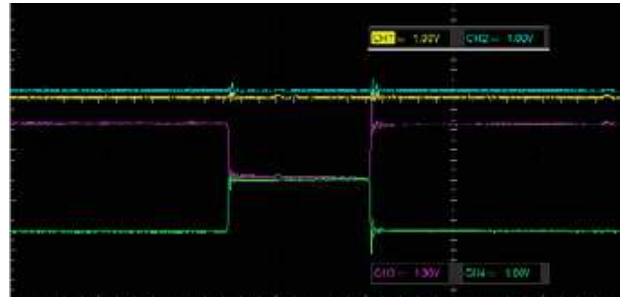
Figura 14. Cortocircuito entre HS CANH a tierra
