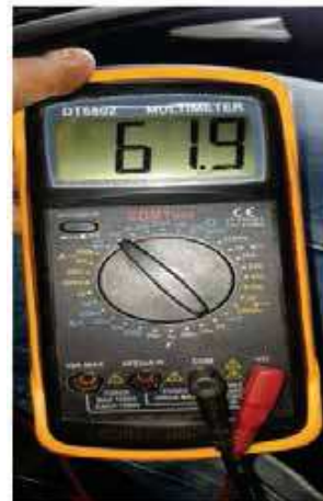
Figura 12. Resultado de medición de resistencia de la red High Speed GMLAN Serial Data.
