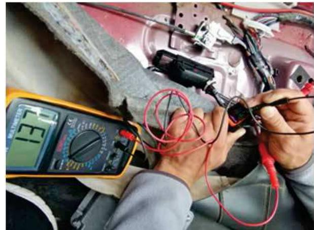
Figura 5; Verificación del valor de resistencia de la red.
