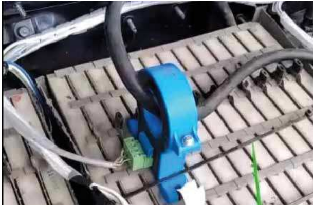
Fig. 4(a). Sensor de corriente conectado al cable positivo de la batería.
