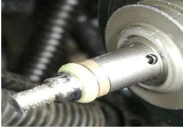
Figura. 14 Impurezas en válvula de regulación de presión del riel
