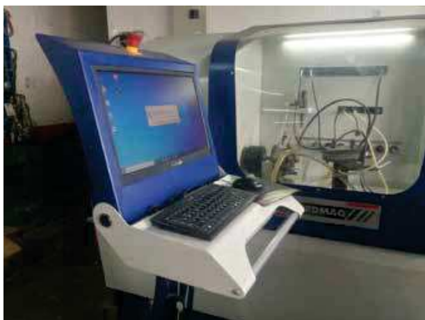
Figura 17. Banco de comprobación de sistemas CRDI Speedmaq
