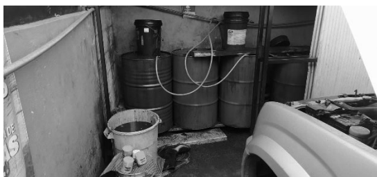
Fig. 6. Áreas no adecuadas para almacenamiento.
