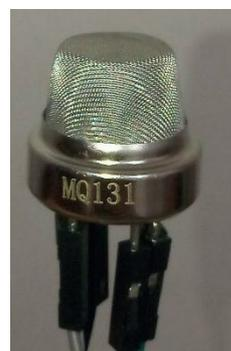
Fig. 2. Sensor MQ131 de alta concentración marca Winsen.
