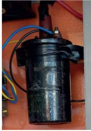
Fig. 6. Bobina de encendido tipo cartucho.
