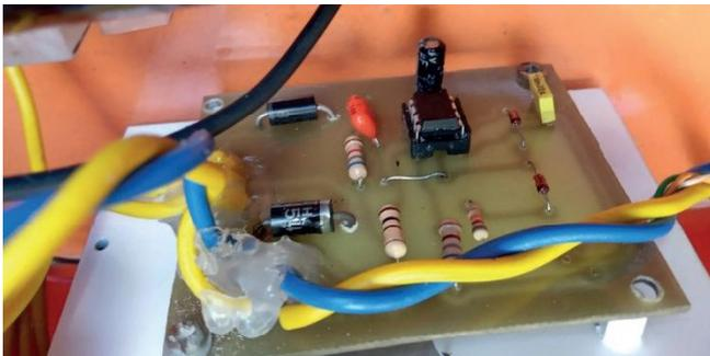
Fig. 11. Circuito oscilador variable.
