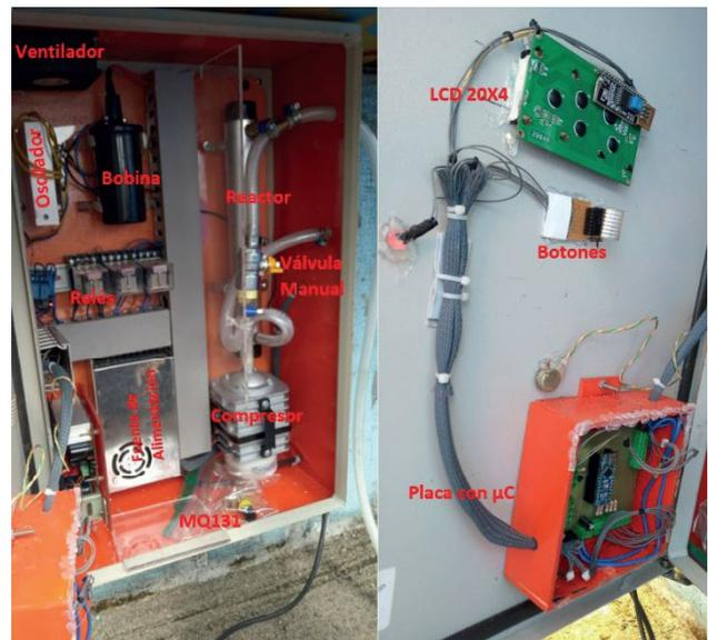
Fig. 9. Interior detallado del equipo generador de ozono.
