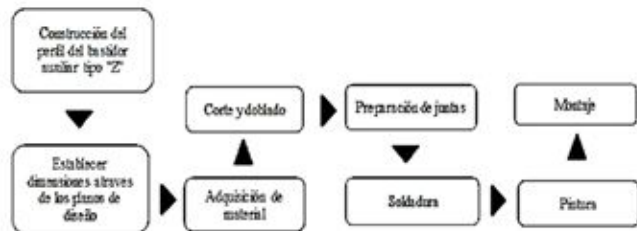
Fig. 16. Proceso de fabricación del bastidor auxiliar para los camiones HINO
