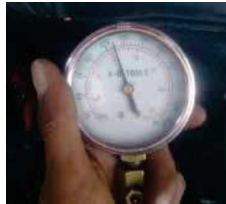
Figura 5. Compresión de los Cilindros en Frio
