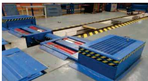
Figura 2. Banco Dinamométrico para Vehículos
