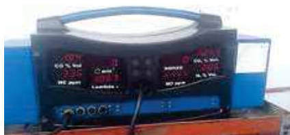
Figura 1. Analizador de gases
