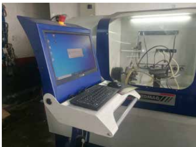
Figura 17. Banco de comprobación de sistemas CRDI Speedmaq
